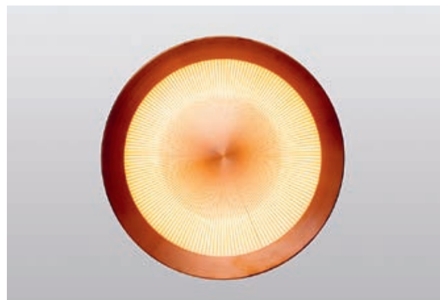
«N.V.L.», LED-Leuchte Monolicht. Das Licht der nicht sichtbaren LED trifft auf die innere Oberfläche der Leuchte, dort spiegeln sich die Strahlen, es entsteht ein diffuses, indirektes Licht.
